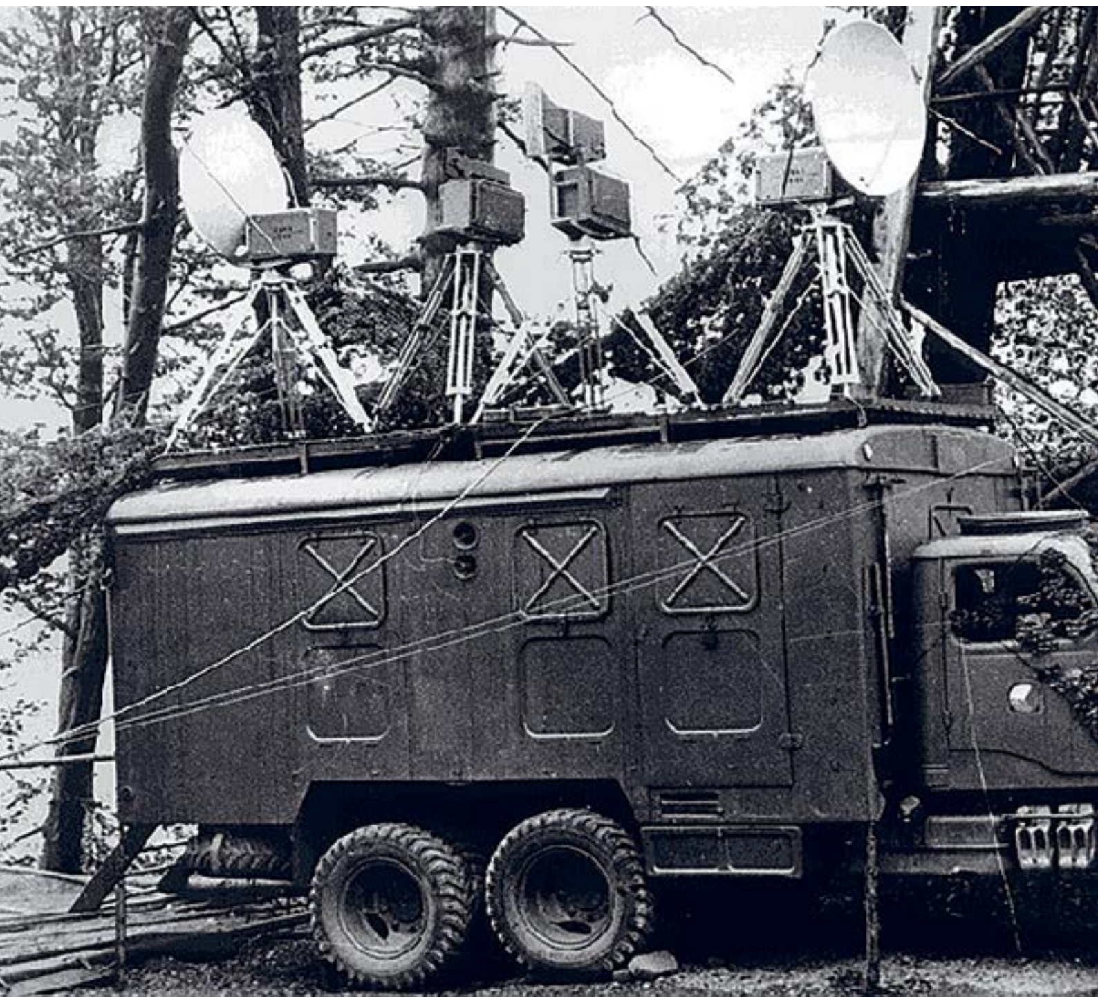
PRVNÍ PASIVNĚ SLEDOVACÍ SYSTÉM KOPÁČ Z DÍLNY PARDUBICKÉ SPOLEČNOSTI ERA
